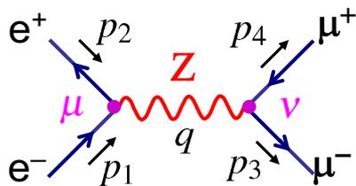
**e<sup>+</sup>e<sup>-</sup> vertex:**  $\bar{v}(p_2) \cdot -ig_Z \gamma^\mu \frac{1}{2} (c_V^e - c_A^e \gamma^5) \cdot u(p_1)$
